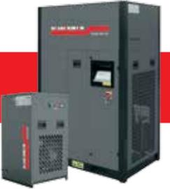
Рефрижераторные осушители серии DRYAIR DK обеспечивают стабильные значения точки росы +3°C даже при тяжелых условиях эксплуатации. Осушители оборудованы двумя магистральными фильтрами грубой и тонкой очистки для очистки воздуха от масла и грубых частиц (остаточное содержание не более 0,01 мг/м³).
